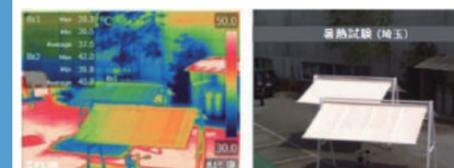
日よけテントを設置して日陰をつくり出すことが、暑熱対策に有効です。体感温度上昇の要因である、日射と赤外放射を大幅カットします。結果、日よけテント下の体感温度は日向と比べると、最大7℃下がります。
